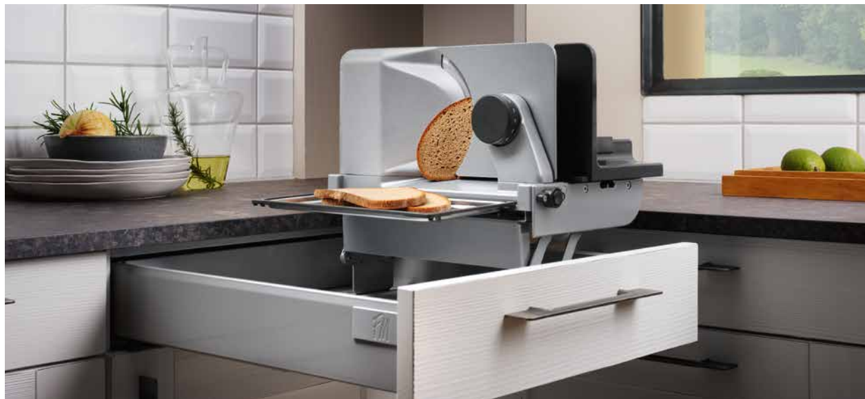
Einbau-Allerschneider, silbermetallic, Breite 34,2 cm, Tiefe 36,5 cm (geklappt), 230 Volt, 65 Watt, Gewicht 4,1 kg, Kurzzeitbetrieb (max. 5 min), Schneidgutführung rechts, einsetzbar für Laden ab einer Breite von 45 cm, Höhe 7,5 cm
